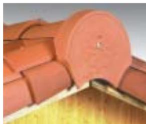
Emploi des tuiles sous-faîtières 2/3 pureau et rives rondes individuelles droite et gauche. Fixation du fronton par vis et rondelle d'étanchéité.
