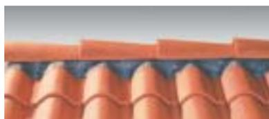
Faîtage réalisé à sec avec faîtière à pureau variable et closoir ventilé, sans emploi de mortier.
